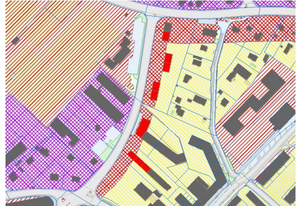
Ave Louis-Pictet (RC75) - dépassement des VLI avant assainissement pour 10 bâtiments
